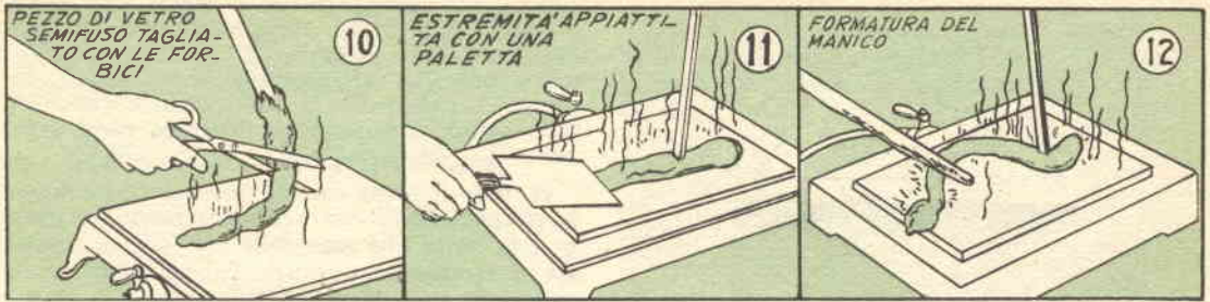
Le tre fasi della lavorazione di un manico di vetro da applicare in seguito ad un oggetto già lavorato; un fornello a gas con sopra una piastra bene levigata, si dimostra di grande ausilio, nel mantenere nelle condizioni di lavorabilità, il vetro che deve essere formato
