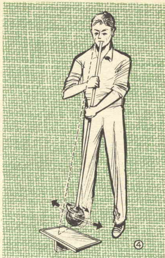
Un sistema suggerito per la soffiatura a mano libera, del vetro, si noti lo specchio inclinato, nella posizione migliore per indicare al soffiatore, il buon andamento della lavorazione. Le frecce indicano il movimento da fare compiere all'oggetto in lavorazione
