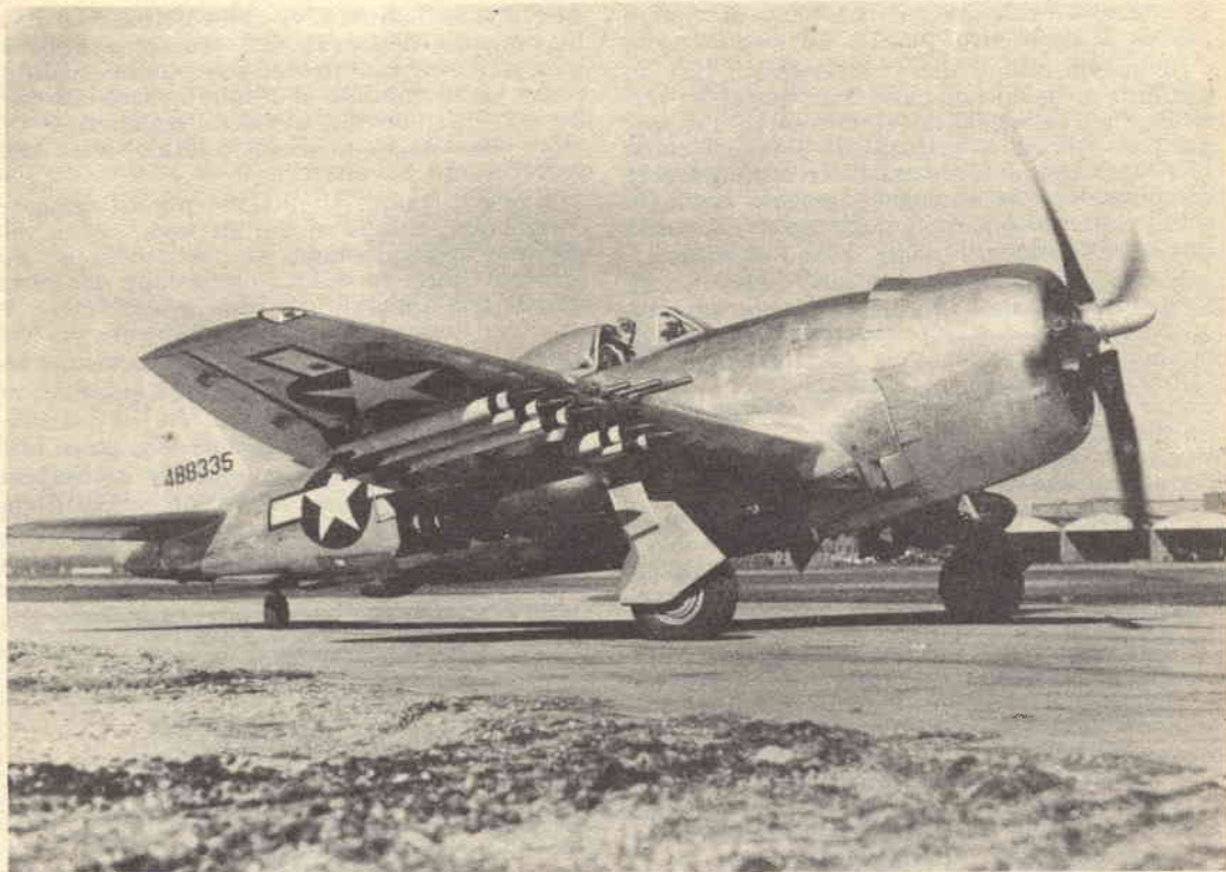
Da questa bella foto del Thunderbolt in decollo per una missione di guerra si possono rilevare numerosi dettagli sulle bombe, i razzi, le mitragliere, il carrello, gli scarichi, ecc.
